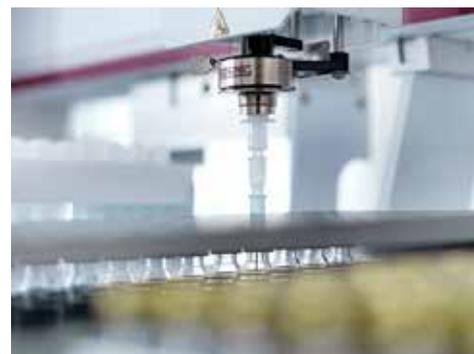
MPS-Filtration-Tray unter Verwendung von 4-mm-Spritzenfiltern
