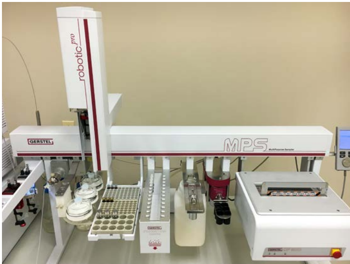
Verwendeter MPS-robotic-pro-Autosampler ausgestattet mit GERSTEL-QuickMix, CF-200 Zentrifuge, SPE- und Filtrations-einheit für die umfangreiche Vorbereitung von Eiprobe n zwecks Bestimmung von Antibiotikarückständen. (Foto: GERSTEL)
