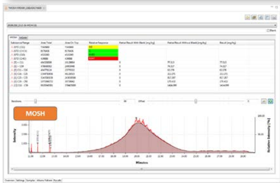
Die Steuerung der Gerstel-MPS-robotic-HPLC/GC-FID-Kompletzlösung für die MOSH/MOAH-Analytik erfolgt aus einer Software heraus, und die Auswertung der Messergebnisse ist erheblich vereinfacht. (2 Darstellungen). Quelle: GERSTEL GmbH & Co. KG
